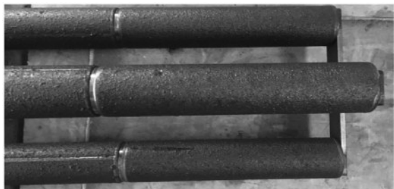
图1 费托反应器过滤管结垢 [9]
