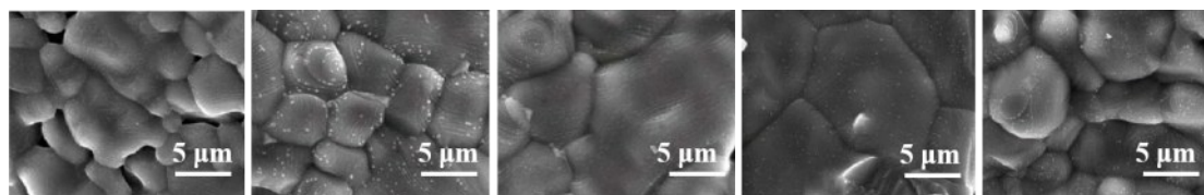
图4 \text{CoO} 添加量对烧结镁砂显微结构的影响 [44]
