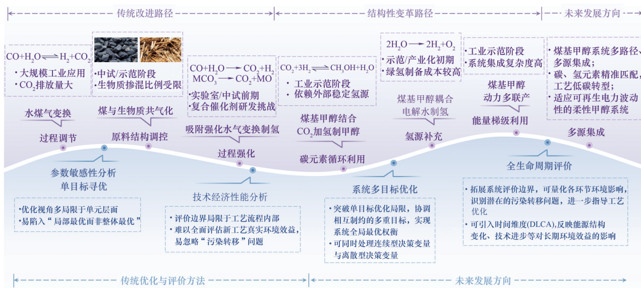
图10 煤基甲醇系统碳氢元素匹配路径总结与未来发展路线图
