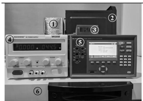
① 实验箱 ② 计算机 ③ 温度控制器 ④ 直流稳压电源 ⑤ 数据采集系统 ⑥ 冰柜
