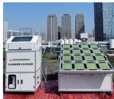
(c) 中石油深圳院平方米级光电制氢装置
