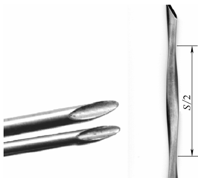
图1 材质 TP2 的内螺纹扭曲椭圆管及其基圆管
